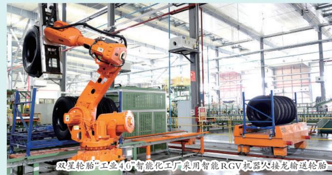
双星轮胎“工业4.0”智能化工厂采用智能RGV机器人接龙输送轮胎
