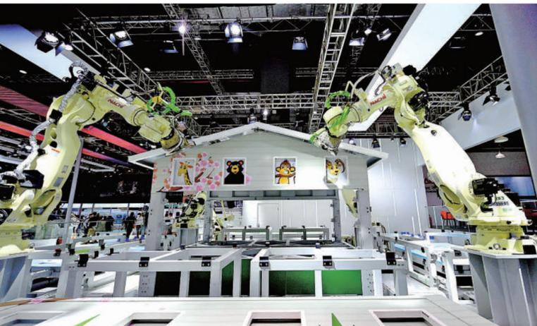
NACHI（那智不二越）4台工业机器人正在搭建一座房子。它们同步挥舞机械臂，既能平稳举起“千斤重”的房屋结构件，又能完成焊接、拧螺丝等“绣花活”。
