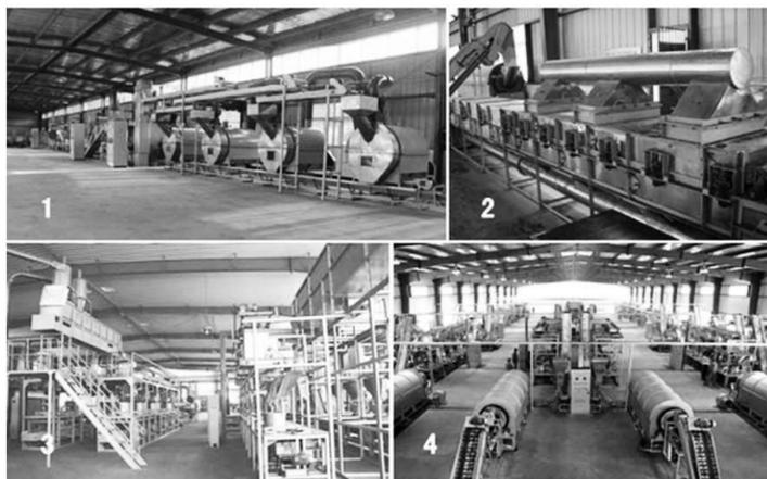
本项目研制的部分清洁化生产线：1.日产1吨炒青绿茶清洁化生产线（休宁茶山）；2.日产50公斤太平猴魁（片形）清洁化生产线（安徽天健）；3.日产2吨滴水香（球形）清洁化生产线（黄山汪满田）；4.四条日产3吨黄山毛峰（条形或尖形）清洁化生产线
