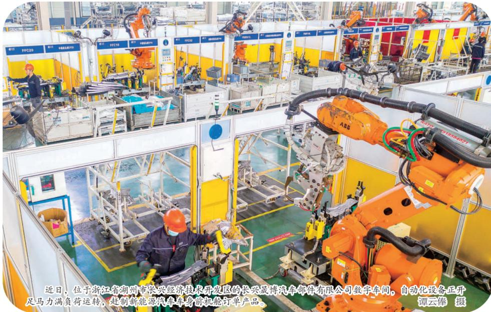
近日,位于浙江省湖州市长兴经济技术开发区的长兴展博汽车零部件有限公司数字车间,自动化设备正开足马力满负荷运转,赶制新能源汽车车身前舱机舱订单产品。
