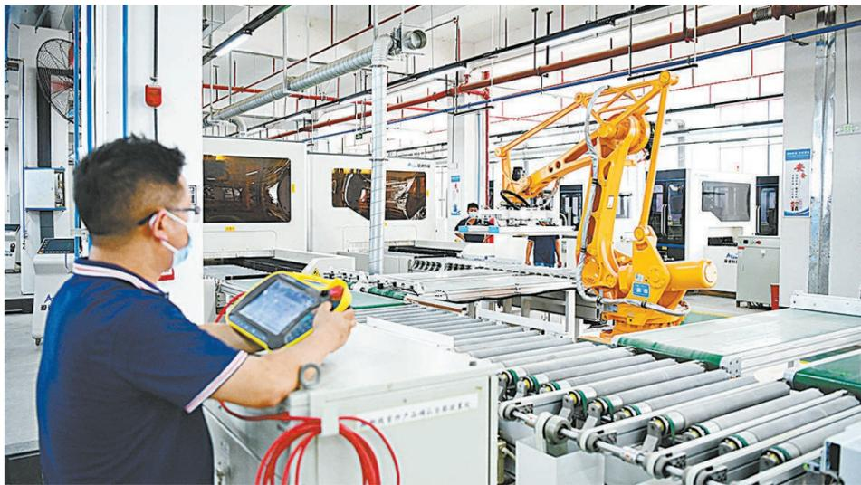
近日，江西省赣州市南康区家具零部件共享配料制作中心，工人在数字化生产线导入编程代码，遥控操作机械臂、传送带和数控切割机智能设备加工零件。
