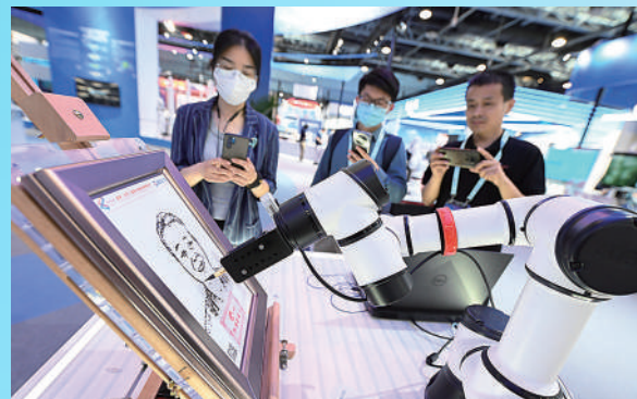
▼AI绘画机器人在“作画”，该款机器人将边缘计算终端、3D视觉、AI算法相结合，模拟出人手绘画的质感。
