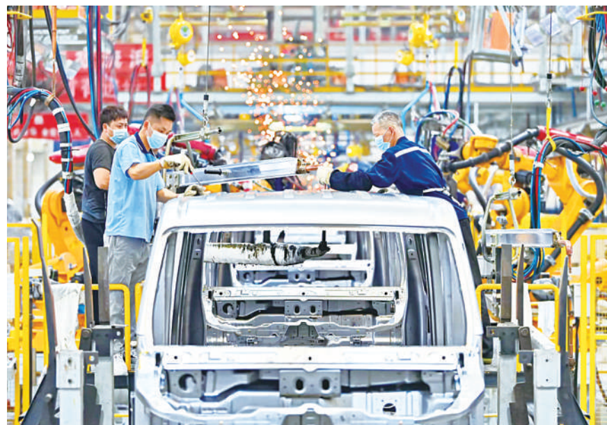
近日,在江西赣州经开区新能源科技城的一家汽车制造公司工人在智能化工厂车间焊接车壳。
