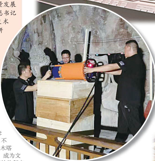
利用X探伤仪对大足石刻卧佛进行内部结构探测
