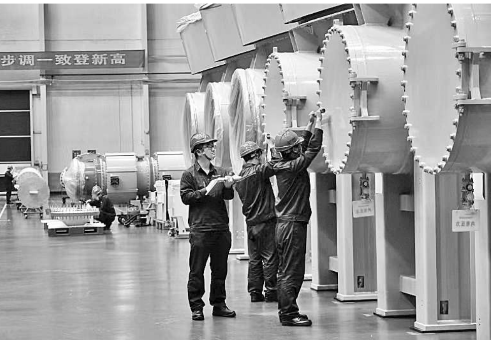
调研组看到，车间技术人员正在对LW13-800滤波器用交流断路器安装情况进行检查。该设备作为特高压直流输电系统中的关键设备，是助力“双碳”和构建新型电力系统的重要利器。
