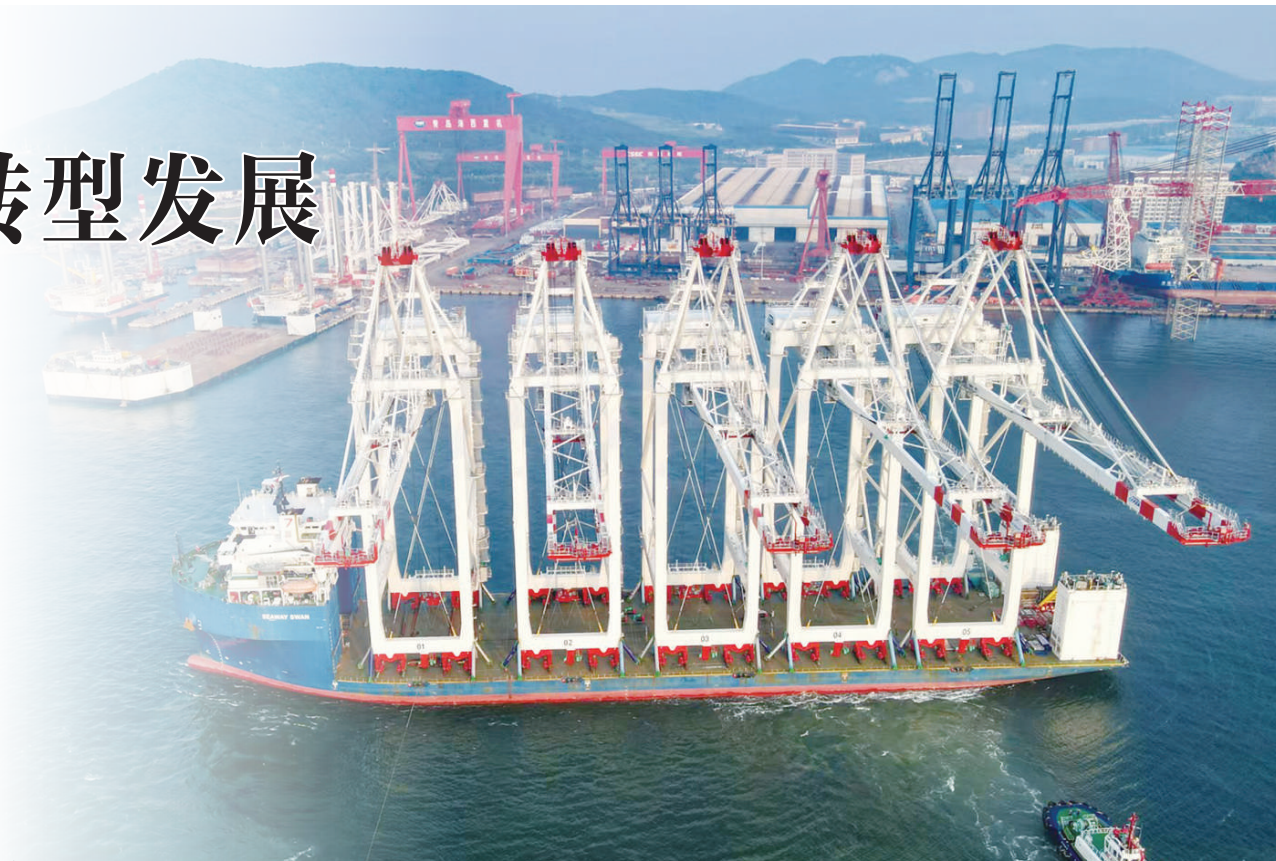
近日，由青岛海西重工有限责任公司为埃及杜米亚特联合集装箱码头打造的首批5台超大岸桥在青岛西海岸新区起运。该批岸桥吊具下起升重量75吨、前伸距72米、轨上起升高度57.5米，是目前世界上该起升能力下起升高度最高的岸桥之一，可满足当前世界最大集装箱运输船的装卸需求。张进刚 摄
